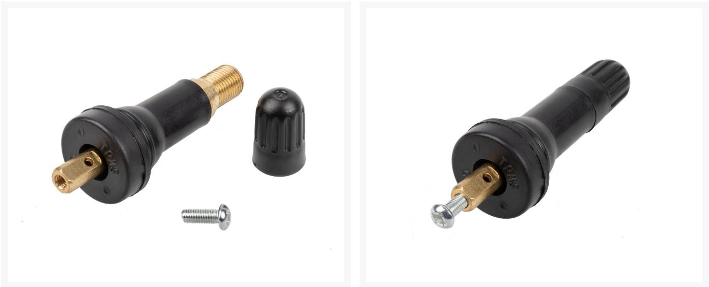
Zawór gumowy do czujników Schrader stosowanych na pierwszym montażu OEM oraz do czujników uniwersalnych Schrade EZ-Sensor. Może być zastąpiony przez zawór aluminiowy.
