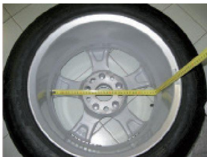
Rysunek F3.3.1 – Przykład ręcznego pomiaru średnicy zewnętrznej (da2) koła w programie ALS1/ALS2
