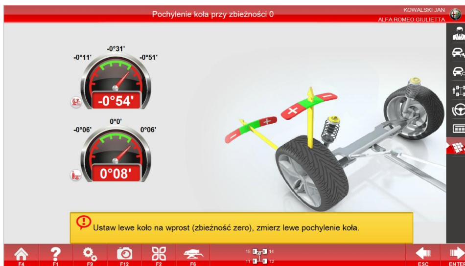
Pomiar pochylenia koła przy zerowej zbieżności_2
