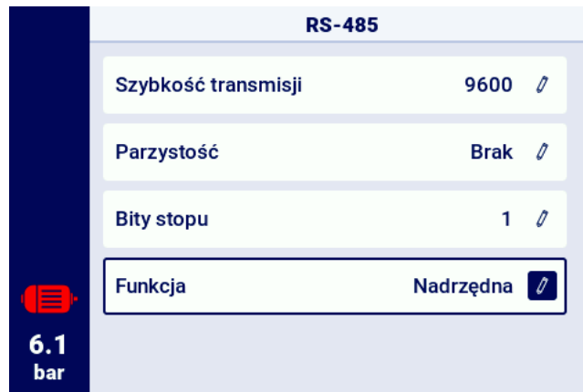
Rysunek 41: Menu konfiguracji portu RS-485
