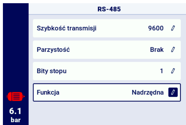
Rysunek 47: Menu konfiguracji portu RS-485
