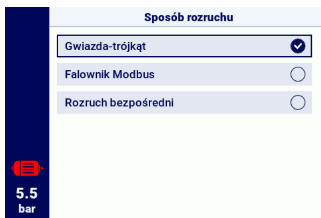
Rysunek 24: Widok menu z ustawieniami sposobu rozruchu
