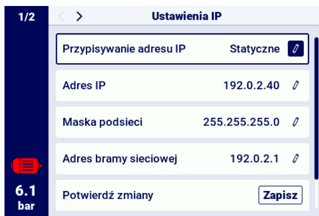
Rysunek 52: Menu konfiguracji adresu IP
