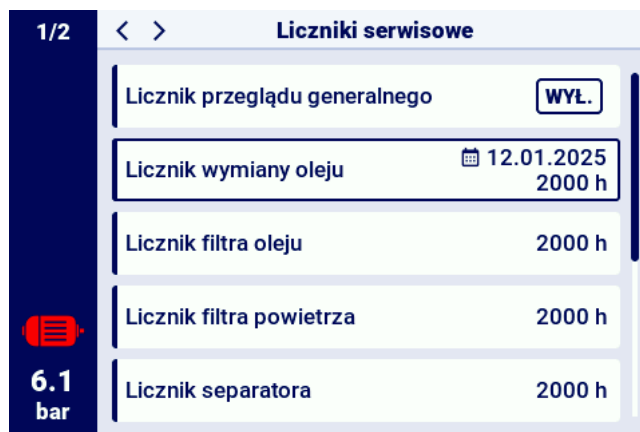
Rysunek 21: Zakładka "Liczniki serwisowe"
