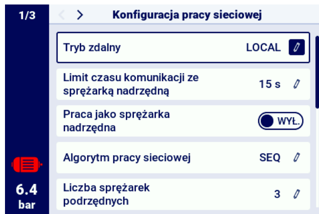
Rysunek 12: Kafelki z parametrami na przykładzie podgrupy parametrów konfiguracji pracy sieciowej
