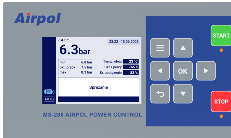
Rysunek 3: Panel frontowy sterownika MS-286
