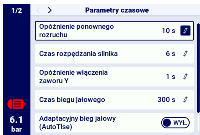
Rysunek 31: Widok menu z ustawieniami parametrów czasowych dla konfiguracji Rozruch Bezpośredni
