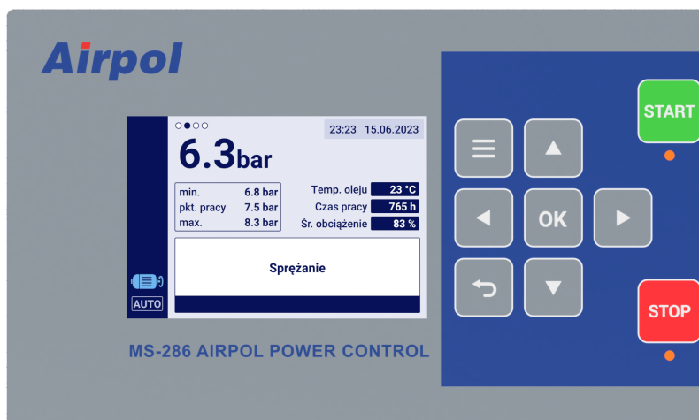
Rysunek 3: Panel frontowy sterownika MS-286
