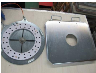
(Demontaż stalowej obrotnicy na dwie części)
