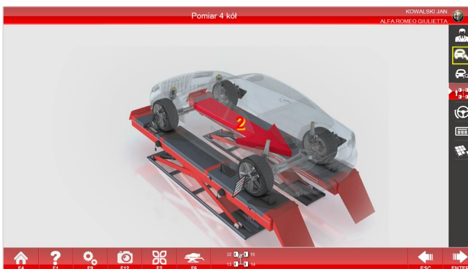
Pomiar kompensacji przez przetaczanie czterech kół pojazdu_3
