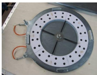
(Element obrotowy stalowej obrotnicy)
