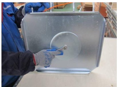
(Demontaż stalowej obrotnicy)
