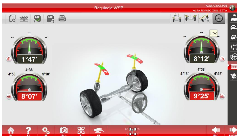
Pomiar kąta wyprzedzenia sworznia zwrotnicy
