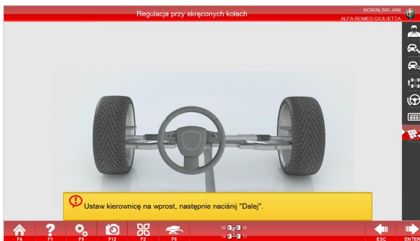
Regulacja zbieżności przy skręconych kołach_1
