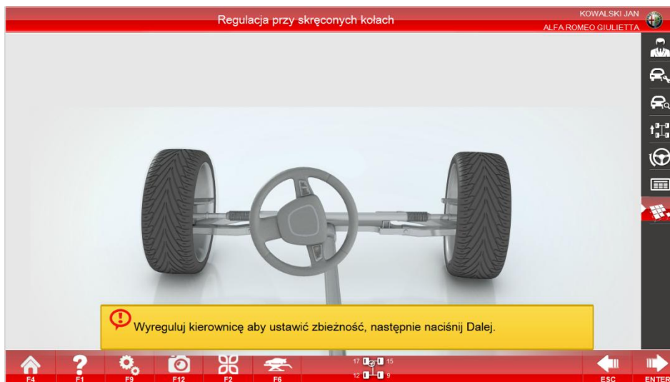
Regulacja zbieżności przy skręconych kołach_2
