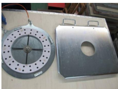
(Demontaż stalowej obrotnicy na dwie części)
