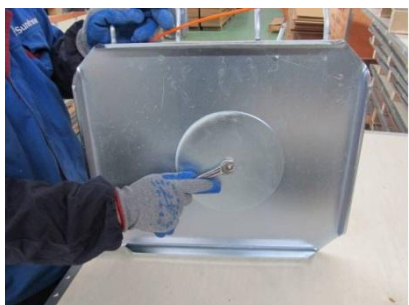
(Demontaż stalowej obrotnicy)
