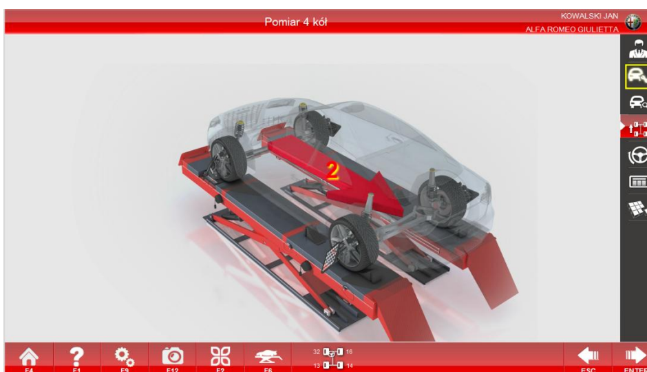
Pomiar kompensacji przez przetaczanie czterech kół pojazdu_3
