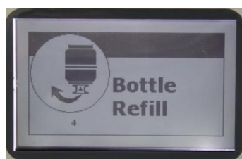
Obraz 11 – Napełnianie butli wewnętrznej
