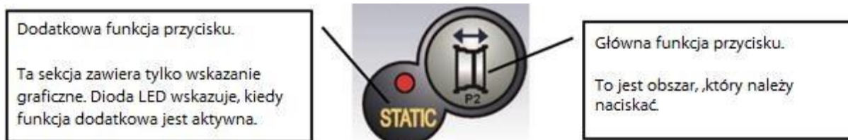
Rysunek F13.2: Przykład przycisku ukazujący funkcje główną i dodatkową
