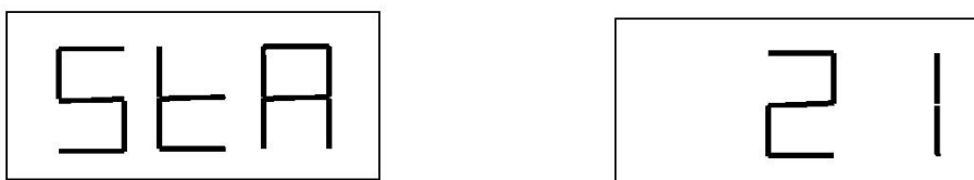
Rysunek F19.3: Włączone wyświetlanie niewyważenia statycznego. Prawy wyświetlacz wskazuje wielkość niewyważenia statycznego.
