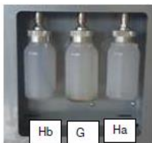
Rysunek 10a – Zbiornik oleju: [G] Zużyty – [Hb] Standard – [Ha] Hybryda
