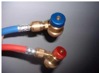
Rysunek 9a – Szybkozłącza wysokiego i niskiego ciśnienia
