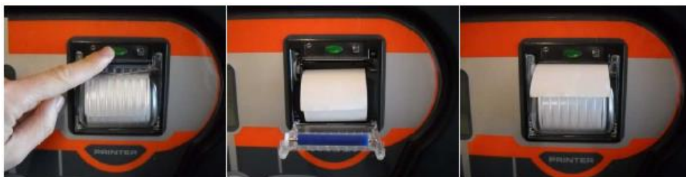
Rysunek 8 – Sposób wymiany papieru
