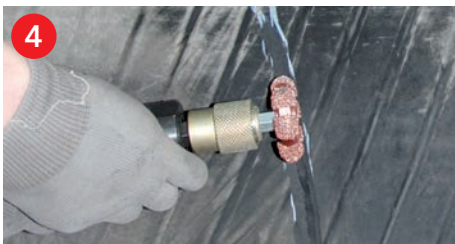
4 Pflaster anzeichnen und Innerliner entfernen Make markings in the tire and remove inner liner
