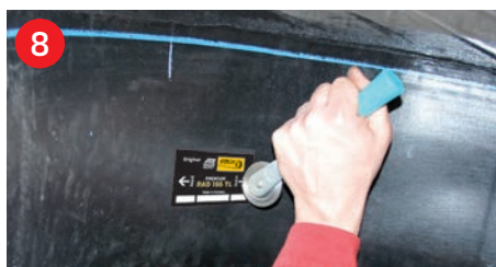
8 Reparaturpflaster ohne Lufteinschlüsse einbauen Install repair patch without air pockets
