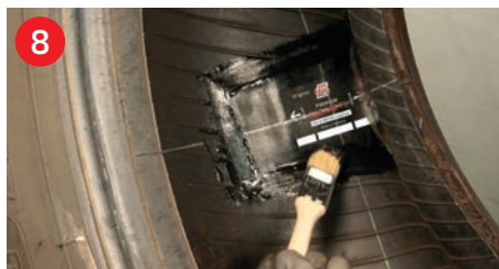
8 Pflasterand versiegeln / 48 h Vulkanisationszeit Seal repair patch edges / 48 h curing time
