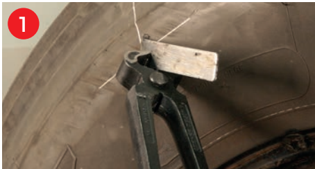
1 Fremdkörper entfernen / Bereich reinigen / Schaden markieren Remove foreign object / Clean area / Mark injury
