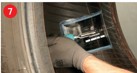
7 Reparaturpflaster ohne Lufteinschlüsse einbauen Install repair patch without air pockets
