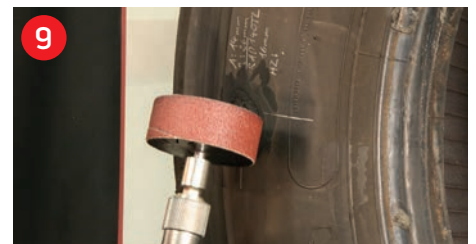
9 Ausvulkanisierte Reparaturstelle verschleifen Buff vulcanised repair area
