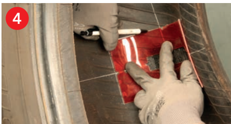
4 Pflaster auswählen und anzeichnen Select repair patch and make markings in the tire
