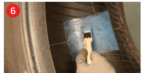
6 Geraute Fläche mit Zement einstreichen Coat buffed area with cement
