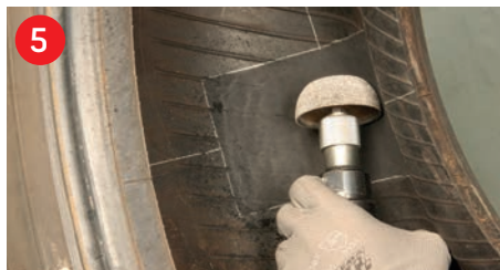
5 Reparaturstelle gleichmäßig rauhen Buff the repair area evenly
